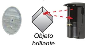
El sensor no polarizado se activa por un objeto brillante que refleja el haz pero cambia la polarización.
